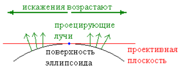
Рис. 4.4.. Возрастание линейных искажений к краям зоны проецирования
