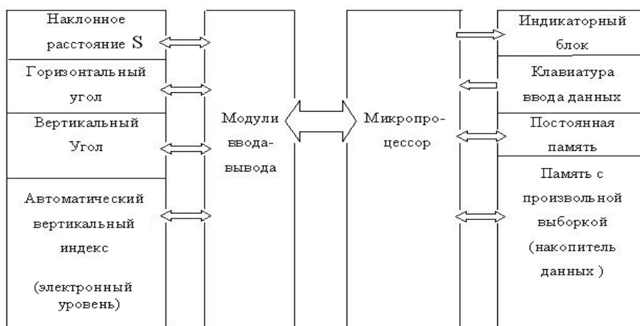
Рис. 4.29 Типовая структурная схема электронного тахеометра
