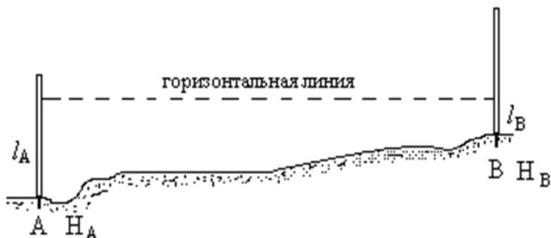
Рис. 3.12 Схема геометрического нивелирования
