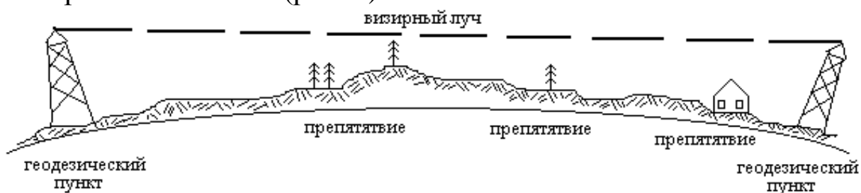
Рис. 1 К расчёту высоты геодезического знака
