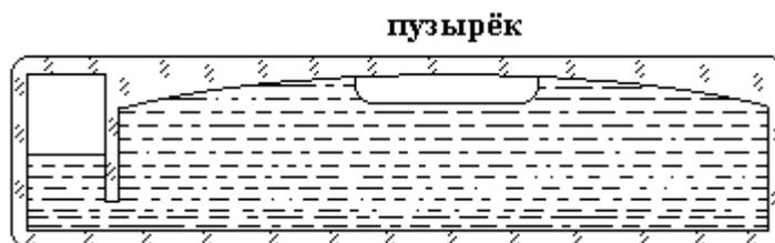
Рис. 2.26 Разрез пузырькового уровня
