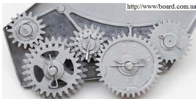
Рис. 2.23 Механический редуктор
