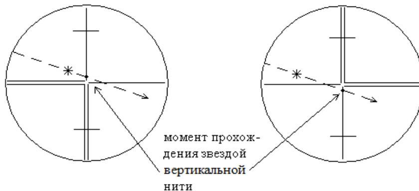
Рис. 12 Прохождение звезды через поле зрения трубы
