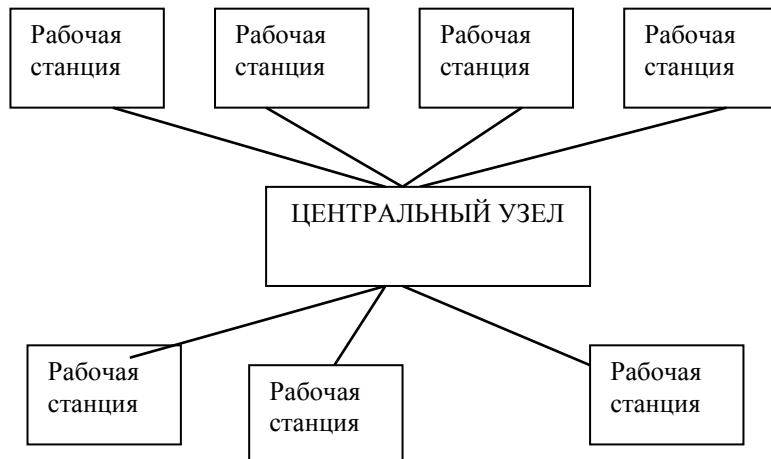
Рис. 7. Схема построения звездообразной топологии ЛВС
